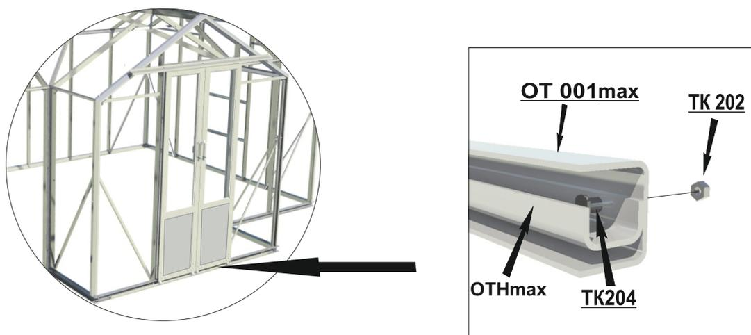
Установить двери в теплицу, так чтобы нижний ролик дверей опирался на направляющую **ОТНmax**, а верхняя вкладка зацеплялась за верхнюю направляющую. Смазать при помощи специальных средств нижние ролики двери и верхние вкладки для лучшего открывания дверей.
